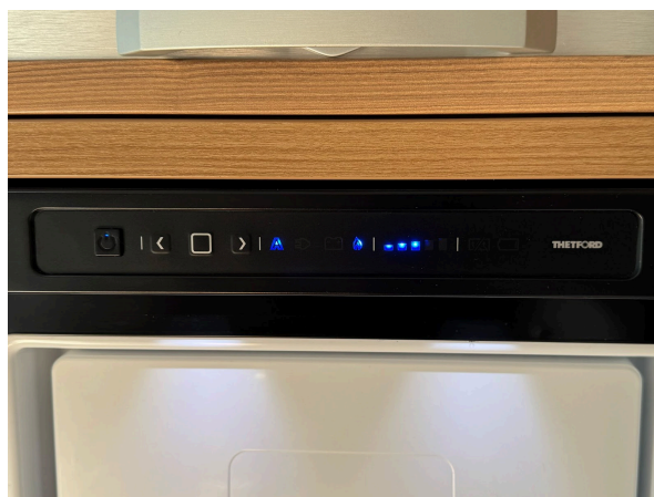
Slika 6.2.: Kontrolna plošča absorpcijskega hladilnika
