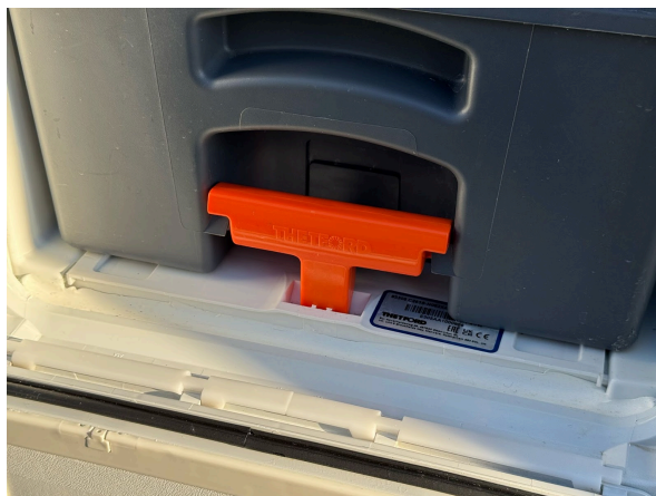
Slika 9.4.: Oranžni zatič mora biti potisnjen v režo
