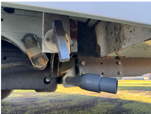
Slika 4.1.: Izpust vode na spodnjem zadnjem delu
