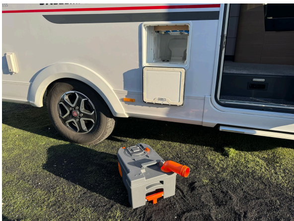
Slika 9.3.: Praznjenje kasete skozi oranžno cev
