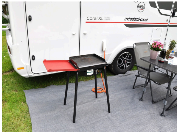
Slika 22.1.: Zunanji žar, priključen preko hitre spojke
