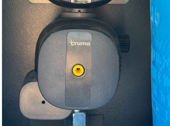
Slika 21.2.: Mono control (crash senzor)
