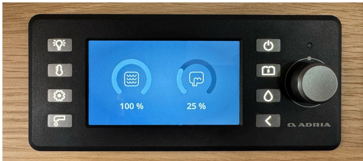
Slika 3.1.: Nivo vode (desna ikona na zaslonu) na komandni plošči Adria. (Za Sunliving glej desni stolpec na sliki 2.1.)
