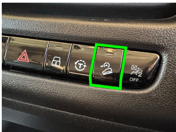
Slika 26.2.: Mesto tipke za Hill Descent Control
